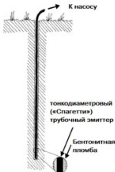
Рис. 12. Схематическое изображение тонкодиаметрового («спагетти») трубчатого эмиттера, устанавливаемого в почву. Бентонитная пломба так же изображена, но используется при необходимости.
