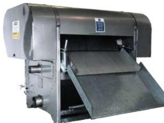
Конструкция из нержавеющей стали в комплекте с запатентованным валом натяжения и скребковой системой, уникальная дизайн “цилиндрической плотины”, само-дренаж – все эти компоненты продляют срок службы, повышают надежность и эффективность **РОТО–скрин®** Сепаратора
