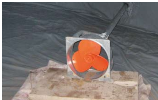
Смеситель с приводом от вала
